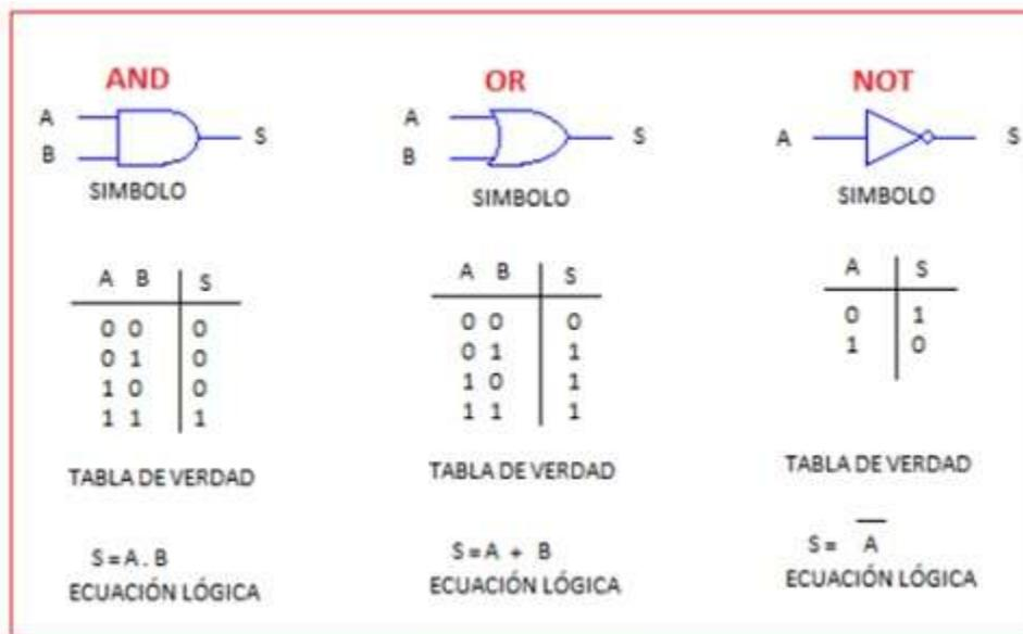
Si a las compuertas anteriores se les niega la salida tenemos la configuración de otras compuertas como la NAND, la NOR. En el cuadro aparece su tabla de verdad con su ecuación lógica. La puerta EXOR es una puerta que se denomina OR EXCLUSIVO y su salida es 1 siempre que las entradas sean diferentes, o sea, entradas, 01 y 10 la salida es 1. Se puede decir que es un comparador. Si las entradas son diferentes la salida es 1 y si son iguales la salida es 0.
