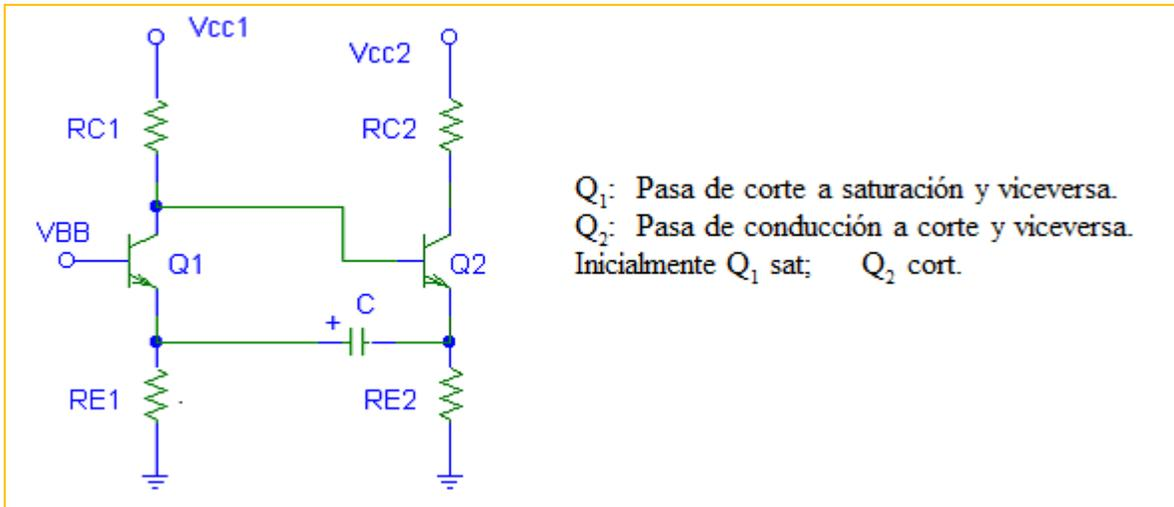
C tiende a cargarse a  $V_{E1}$ , como  $V_C$  aumenta, entonces  $V_{E2}$  disminuye. Si  $V_{E2} < V_{B2} - V_{r2}$  entonces,  $Q_2$  conduce y  $Q_1$  corte
