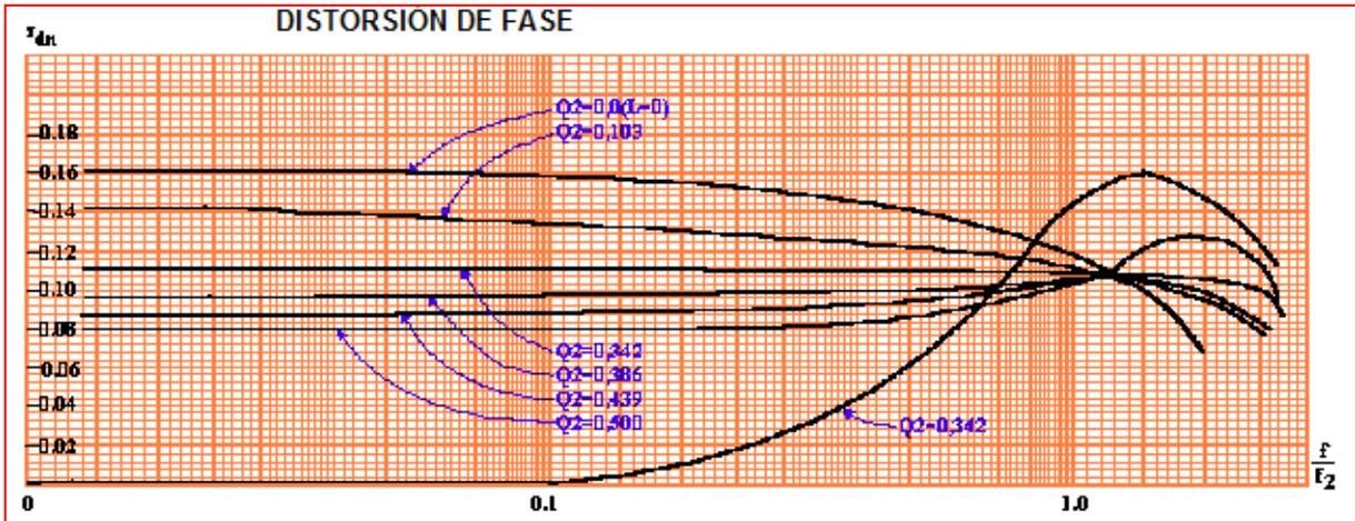
Cuando  $Q_2 = 0$  la respuesta es la de un amplificador sin compensar. Al aumentar  $Q_2$  aumenta el ancho de Banda. Graficando las dos últimas funciones se ve que la amplificación cae bruscamente para valores de  $Q_2$  entre 0,0 y 0,439 y comienzan a aparecer picos para  $Q_2$  mayores a 0,5. Para no tener picos de sobretensión se emplea un  $Q_2$  óptimo de 0,439.
