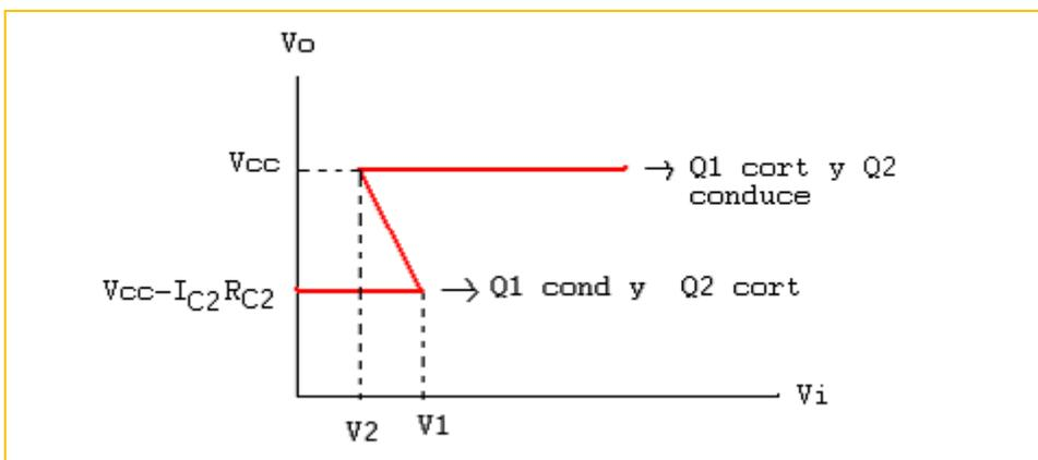
Cuando  $V_i > V_1$ , el circuito realizará una transición brusca a su nivel superior ( $V_o = V_{cc}$ ). Estando en este nivel alto al disminuir  $V_i$ , la salida permanecerá en éste nivel hasta que  $V_i = V_2$ . Si  $V_i < V_2$  el circuito pasará bruscamente al nivel inferior. En resumen, el circuito presenta *histéresis*, o sea, que producen las transiciones para valores diferentes de  $V_i$ .
