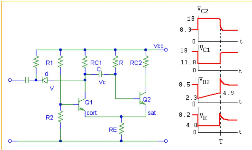
En el circuito se ha eliminado el acoplamiento en el colector de  $Q_2$  y la base de  $Q_1$ ; la realimentación regenerativa se efectúa a través de  $R_E$ . El ancho de pulso  $T$  varía linealmente con el valor de la tensión  $V$ .
