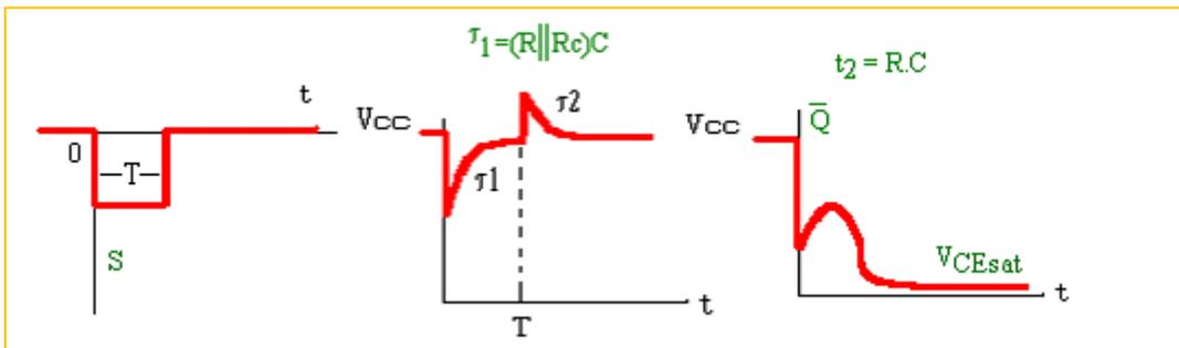
El disparo asimétrico de un biestable es usado para este circuito flip flop R-S (set reset).
