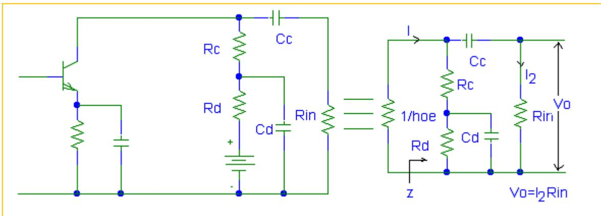
$Z \ll 1/h_{oe} \quad R_d \gg X_{cd}$ , entonces se puede despreciar  $h_{oe}$  y  $R_d$ .
