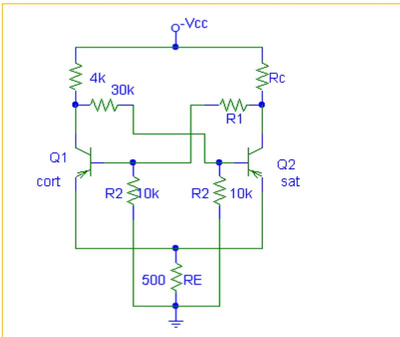
Para simplificar el circuito se realizan los equivalentes Thevenin en el colector y en la base de  $Q_2$ .
