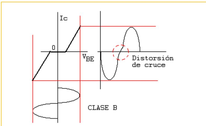
Observando la forma de la señal de salida  $I_c$  se nota la distorsión de cruce. Esta es debida a que la corriente característica de transferencia tiene adicionalmente un valor de  $V_{BE}$  para que la corriente de colector deje de ser cero. La alimentación de tal distorsión se realiza polarizando los transistores en clase AB, o sea, con una polarización un poco mayor a la de corte.
