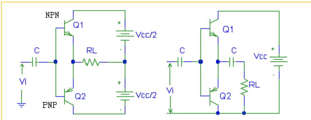
El condensador C en ausencia de señal se carga a un voltaje  $V_c = V_{cc}/2$
