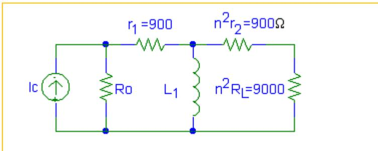
$$r_2 = \text{resistencia del secundario} = R_L/10 = 1\Omega$$
