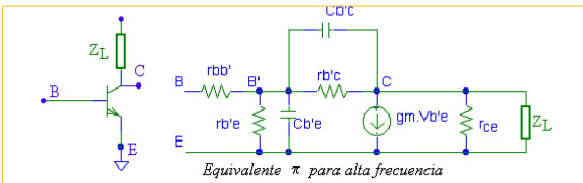
El circuito equivalente anterior se puede reemplazar por el siguiente circuito.
