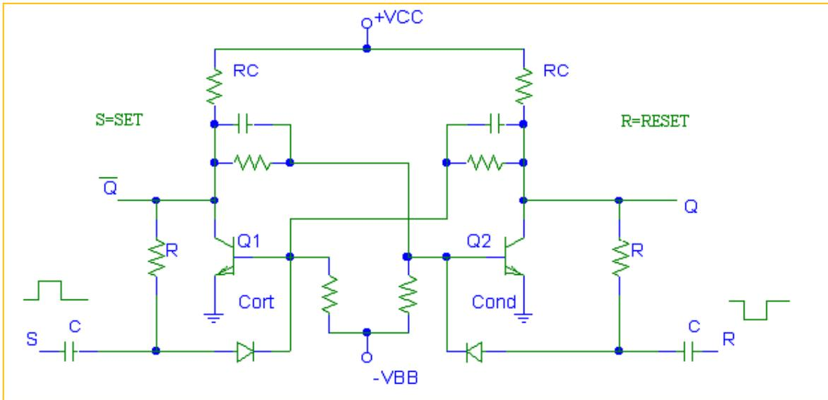
En la figura anterior se muestra un disparo asimétrico por base. Los diodos evitan la transición de estados a los frentes positivos de los pulsos de entrada. En ausencia de pulsos, ninguno de los diodos conduce.  $R \approx 5$  a  $10$  veces  $R_c$
