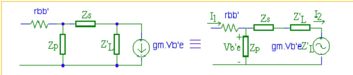
$$v_{b'e} = Z_p(I_1 - I_2) \quad (1)$$
