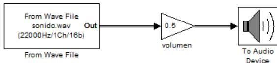
Los bloques se encuentran en el Toolbox de Signal Processing, como Source y Sink
