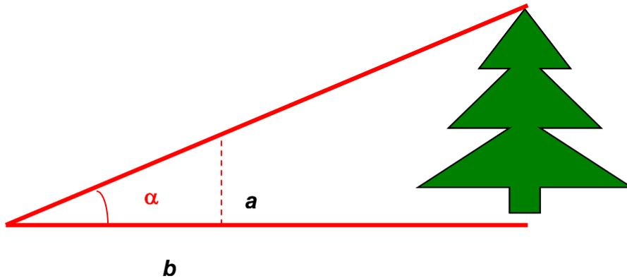
Para medir la altura del árbol se hace la reflexión o método trigonométrico como se indica en la figura. si se miden las distancias  $a$  y  $b$  de la figura y la distancia  $x$  del árbol, hallar la altura y del árbol.
