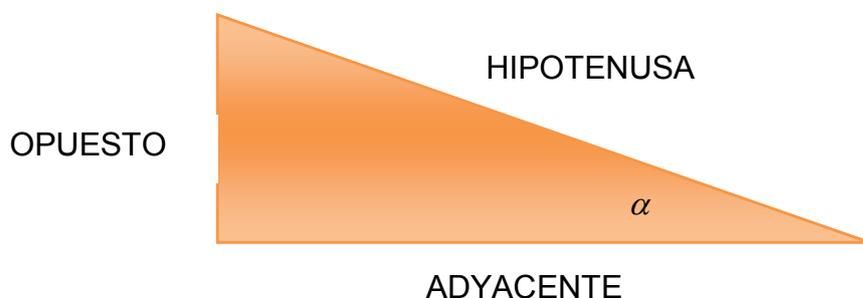
En un triángulo rectángulo (aquél que tiene un ángulo de 90°),  $\text{sen}\alpha$  es la razón entre el cateto opuesto y la hipotenusa,  $\text{cos}\alpha$  es la razón entre el cateto adyacente y la hipotenusa y la  $\text{tan}\alpha$  es la razón entre el cateto opuesto y el cateto adyacente.
